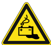
U1120 Warnung vor Ge- fahren durch das Aufladen von Batterien (W026)
