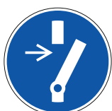
U1314 Vor Wartung oder Reparatur freischalten (M021)
