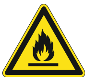
U1101 Warnung vor feuergefährlichen Stoffen (W021)
