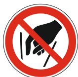
U940 Hineinfassen verboten (P015)
