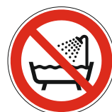
U946 Verbot, dieses Gerät in der Badewanne, Dusche od. über mit Wasser gefülltem Becken zu benutzen (P026)
